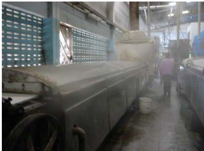
รูปที่ 2-3 แสดงการผ่านน้ำแป้งลงสายพานเข้าสู่อุโมงค์ไอน้ำ
