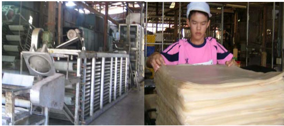
รูปที่ 2-4 แสดงทำแห้งโดยผ่านแผ่นกล้วยเดี่ยวสดในตู้อบลมร้อนและการฝั่งลม
