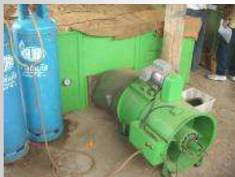
เครื่องอบแห้งแบบกระบอกใช้ความร้อนจากแก๊สหุงต้ม
