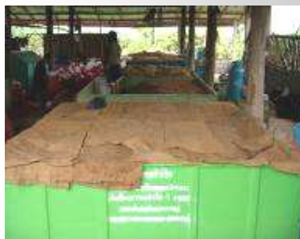
เครื่องอบแห้งแบบกระบอกใช้ความร้อนจากแก๊สหุงต้ม
