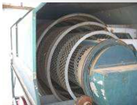
เครื่องร่อนคัดเกรดลำไย ช่าย-ขนาดเล็ก และชวา-ขนาดใหญ่
