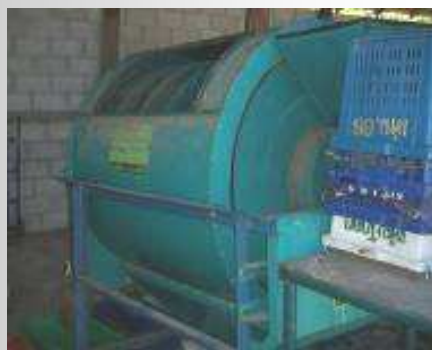
เครื่องร่อนคัดเกรดลำไย ช่าย-ขนาดเล็ก และชวา-ขนาดใหญ่
