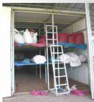
เตาอบแบบไอร้อน และไอน้ำที่สร้างโดยใช้วัสดุห้องเย็นเป็นผนังห้องอบแห้ง
