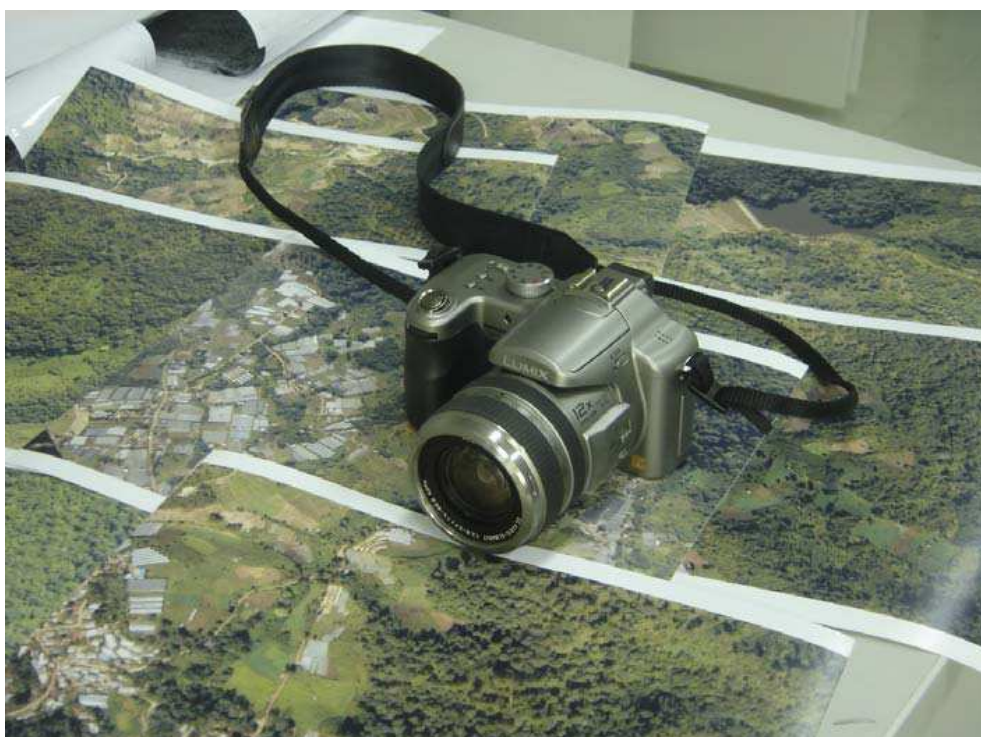
รูปที่ 3: กล้องถ่ายรูปเชิงเลขความละเอียด 8 ล้าน pixels ใช้ในการถ่ายภาพ
